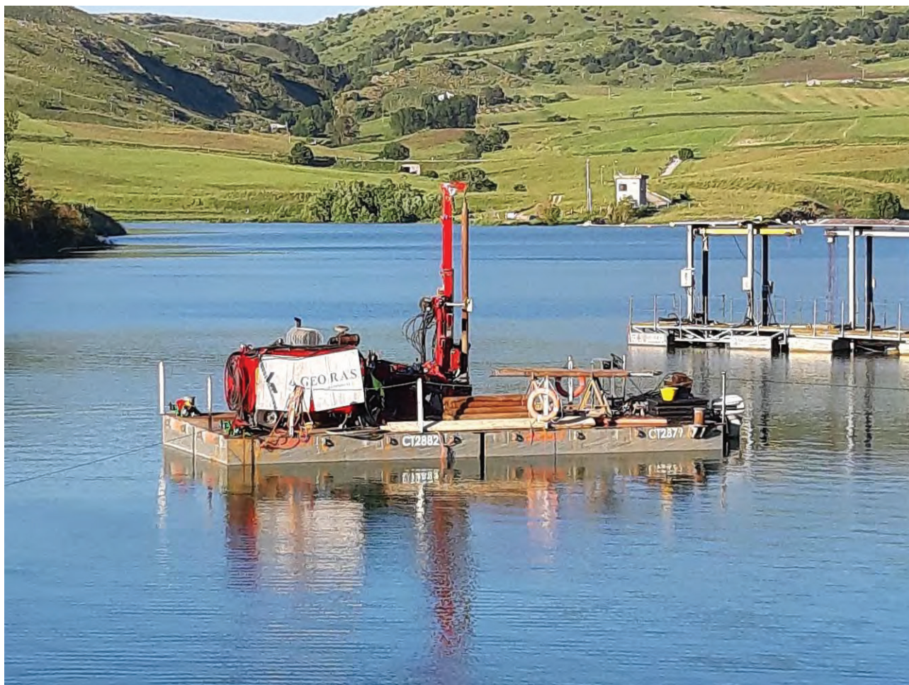
Foto 5: perforatrice su pontone modulare galleggiante impiegata per la caratterizzazione dei sedimenti
