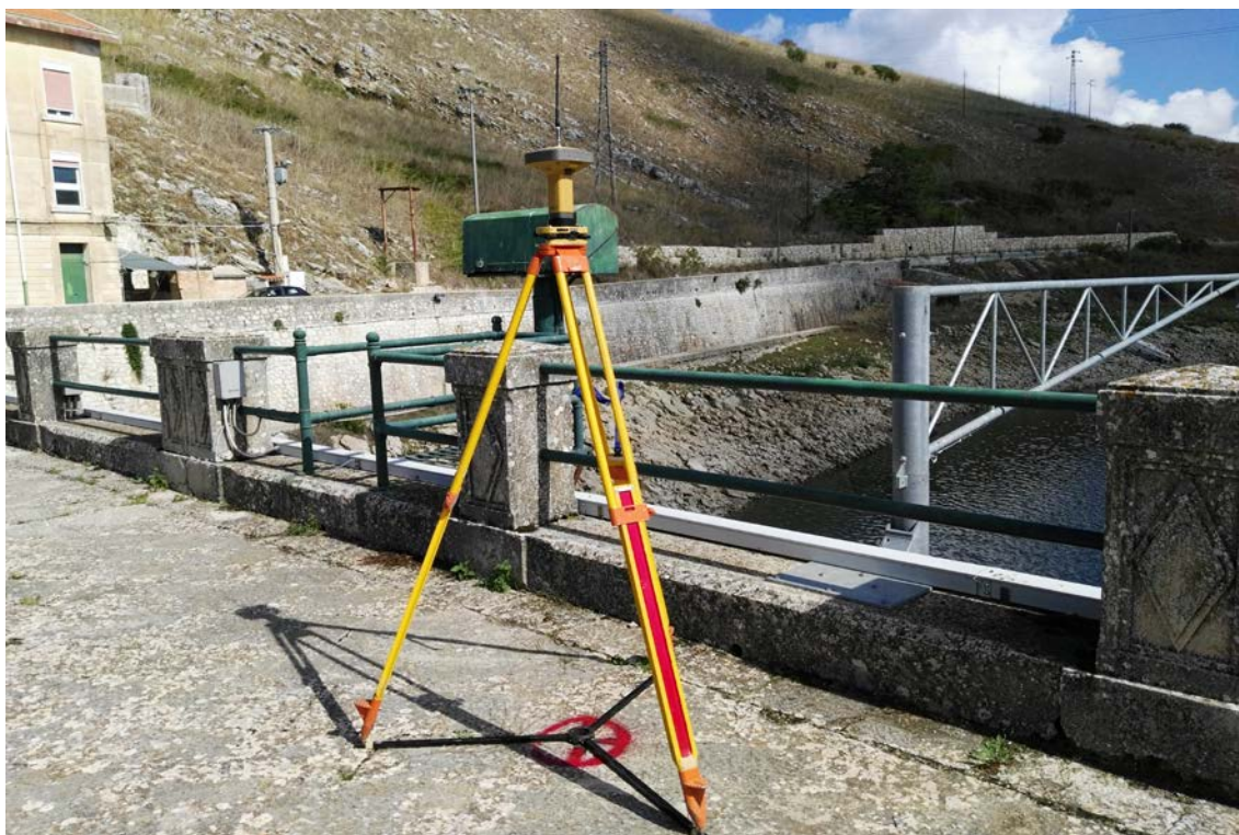
Figura 3. – Installazione sistema GPS RTK su caposaldo per la verifica strumentale
