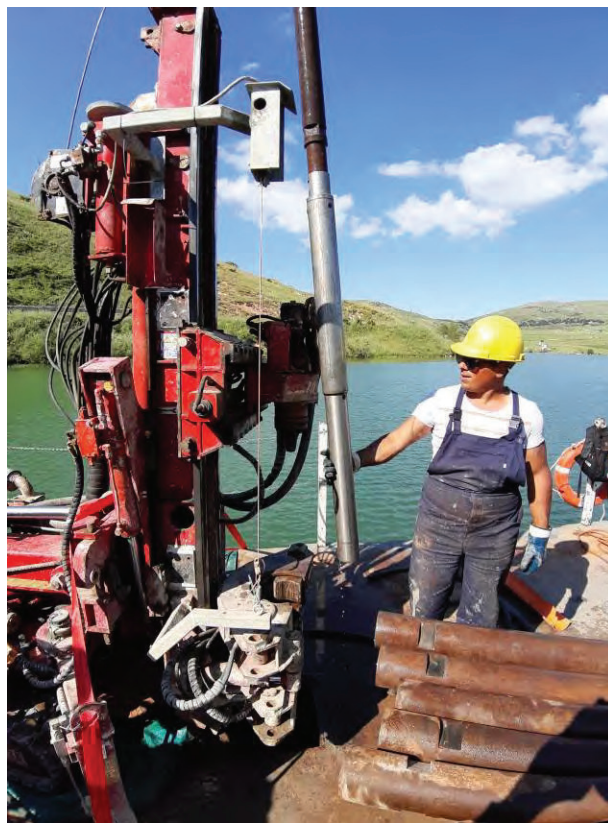
Foto 7: Tentativi di prelievo dei campioni indisturbato con campionatore Osterberg
